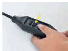
4. Stiskněte tlačítko RESET, ukazatel se rozsvítí červeně. RCD zástrčka funguje
