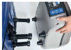
3) Odšroubujte tři konektory z čerpací jednotky.
